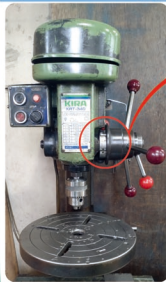
ボール盤には目盛りがついて、穴の深さを設定することもできます。
